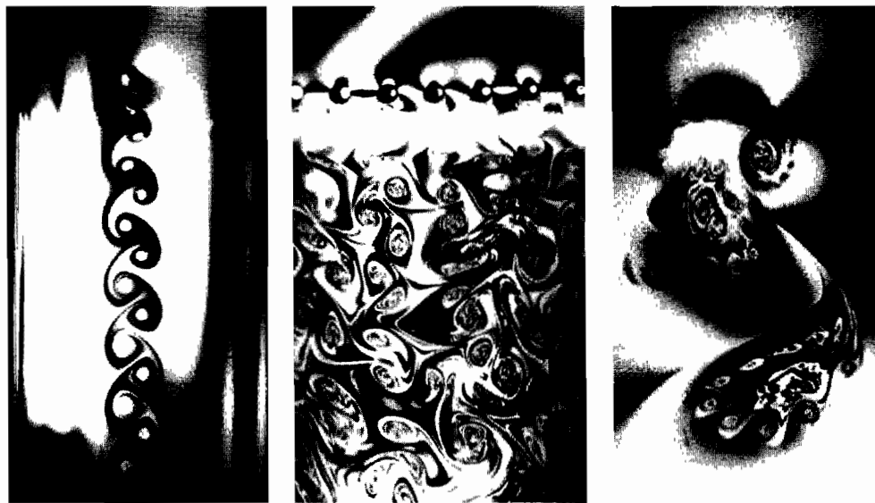
Рис. 5.2. Примеры турбулентных потоков, в которых видны проявления регулярной повторяемости формы в хаосе. (Фотографии потоков в мыльной пленке сделаны Маартеном Рютгеном (в то время он работал в Государственном университете штата Огайо), Сяо-Лунь Ву и Уолтером Гольдбергом (Университет Питсбурга).)
