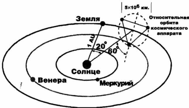
Рис. 9.7. LISA, космическая антенна лазерного интерферометра. Предполагаемое развёртывание трех спутников в виде треугольного интерферометра с длиной каждой стороны 5 млн км. (Схема предоставлена Лабораторией Джет Пропалшн, Калифорнийский технологический институт, Пасадена, штат Калифорния.)
